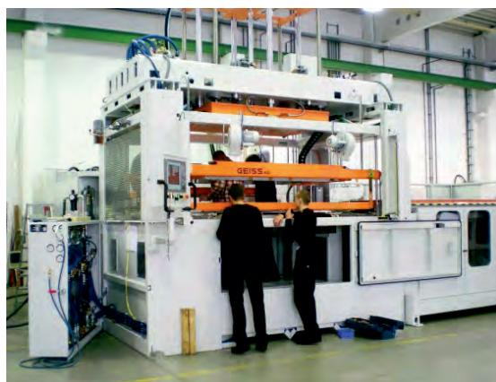
Внешний вид вакуумформовой машины TweenSheet
